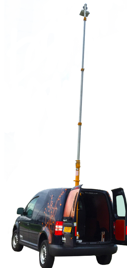
Site Survey Meetwagen met telescopische mast
